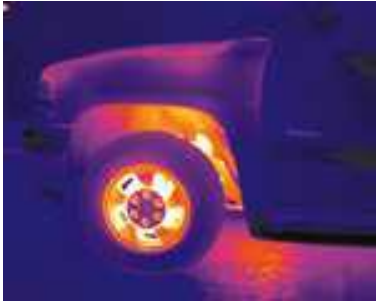
Inspection des freins.
