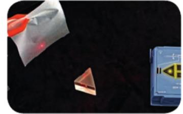
Les prismes du laboratoire sont souvent en flint, un verre très dispersif et très réfringent. À la sortie d'un prisme en flint, le rayon émis par un laser rouge ( $\lambda = 630 \text{ nm}$ ) traverse la surface qui sépare le flint (milieu incident) de l'air. L'angle d'incidence est de  $48^\circ$ . L'angle réfracté est de  $26^\circ$ . L'indice de réfraction de l'air est  $n_{\text{air}} = 1,00$ .
