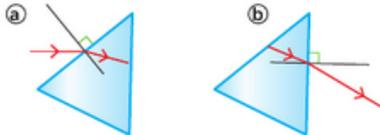
2. Un prisme est réalisé dans un matériau dont l'indice de réfraction varie en fonction de la longueur d'onde et donc de la couleur.
