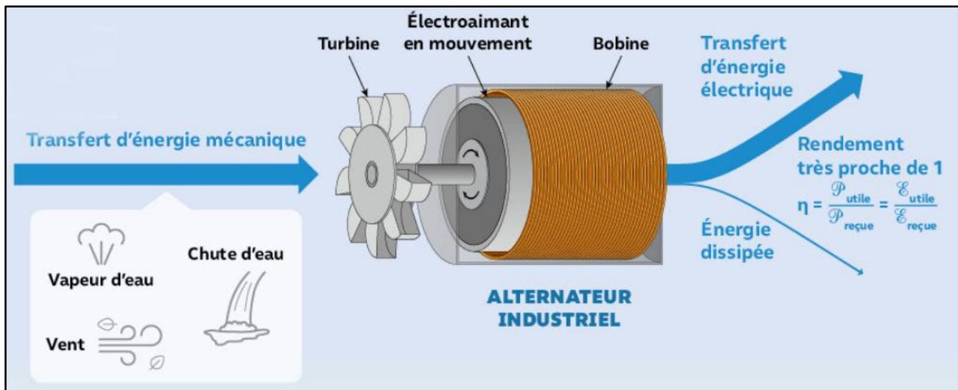
Toute l'énergie mécanique n'est pas convertie en énergie électrique. Les pertes peuvent être dues.....ou encore à .....
